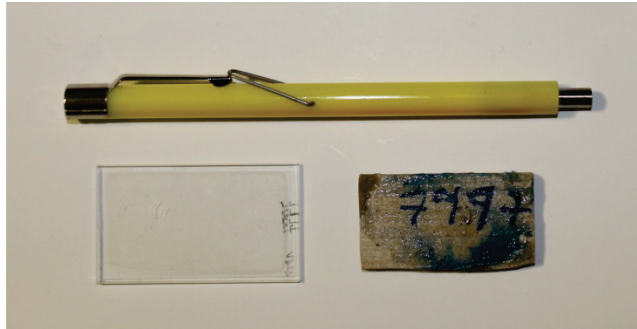
Abb. 2: Dünnschliff der zu untersuchenden Gesteinsprobe. (Magnetstift = 12,5 cm)
