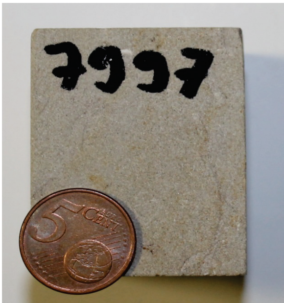
Abb. 1: Makroskopische Ansicht der Probe 7997. Das Handstück zeigt eine hellgraue Gesamtgesteinsfarbe. Das Gestein besitzt ein gleich- und sehr feinkörniges Gefüge. Einzelne Komponenten können makroskopisch nur schwer identifiziert werden. (Durchmesser Münze = 2,1 cm)
